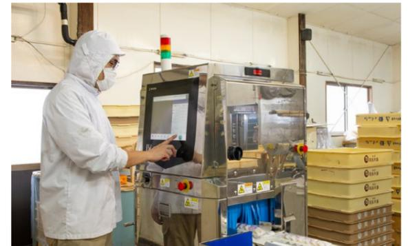
▲X線異物検査装置の導入
